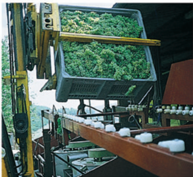
AGRIBOX Ref. 1096 F4 en máquina de volteo sobre lagar.
